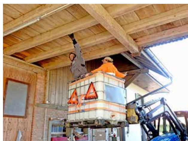
Der Frontlader des Traktors ist so ausgestattet, dass die «Nestreiniger» sicher arbeiten können.
